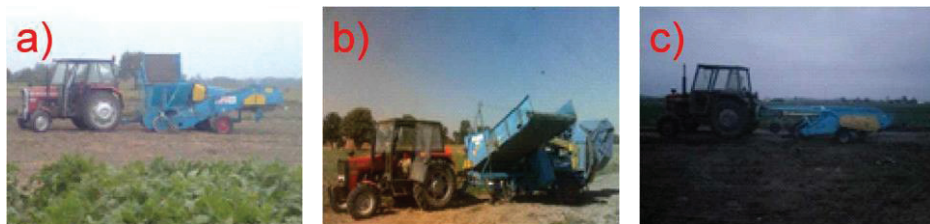
Rysunek 1. Widok obecnie najczęściej stosowanych technologii zbioru selera korzeniowego: a - ciągnik + kombajn ziemniaczany Bolko, b - ciągnik + kombajn ziemniaczany Anna, c - ciągnik + kopaczka elewatorowa
