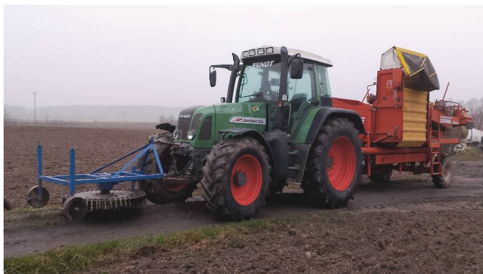
Rysunek 4. Widok prototypu ogławiacza zawieszonego na przednim TUZ-ie ciągnika współpracującego z kombajnem do ziemniaków Grimme
