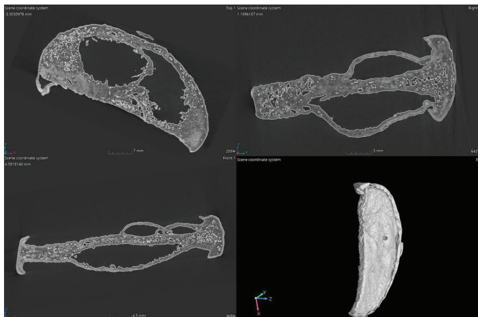
Rysunek 1. Przykładowy obraz z mikrotomografu komputerowego wysuszonych jabłek wstępnie odwadnianych w zagęszczonym soku aroniowym (A 33%)
