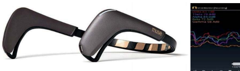
Rysunek 3. Szczegółowy przebieg trasy; a - Opaska EEG Muse InteraXon 2, b - aplikacja Mind Monitor
