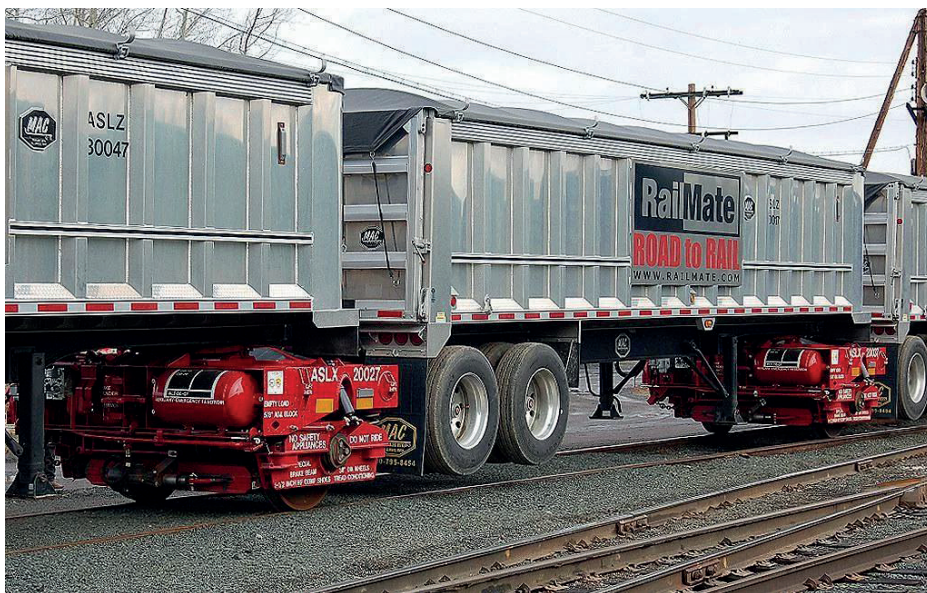
Rysunek 4. System RoadRailer eksploatowany w USA przez firmę Triple Crown, spółkę zależną Norfolk Southern Railway
