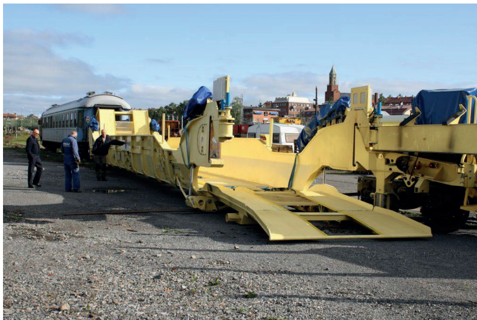
Rysunek 10. Wagon ze specjalistycznym wózkiem do załadunku w terminalu naczep siodłowych systemem Flexiwaggon
