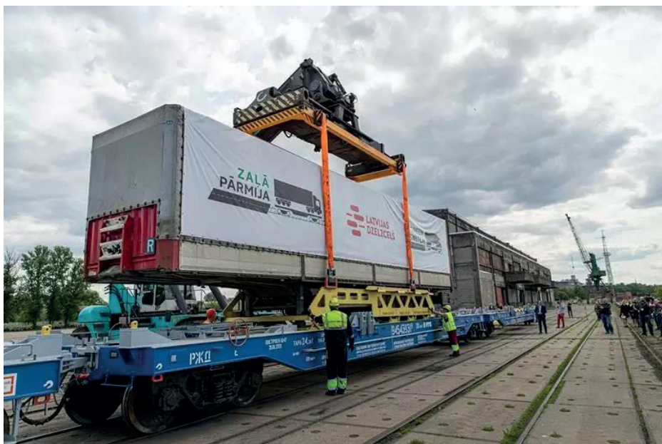
Rysunek 3. Transport intermodalny naczep metodą Trailer On Flat Car (TOFC) / piggyback
