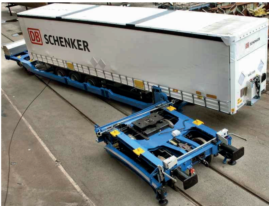
Rysunek 11. Specjalistyczny wagon do załadunku w terminalu naczep siodłowych systemem Megaswing
