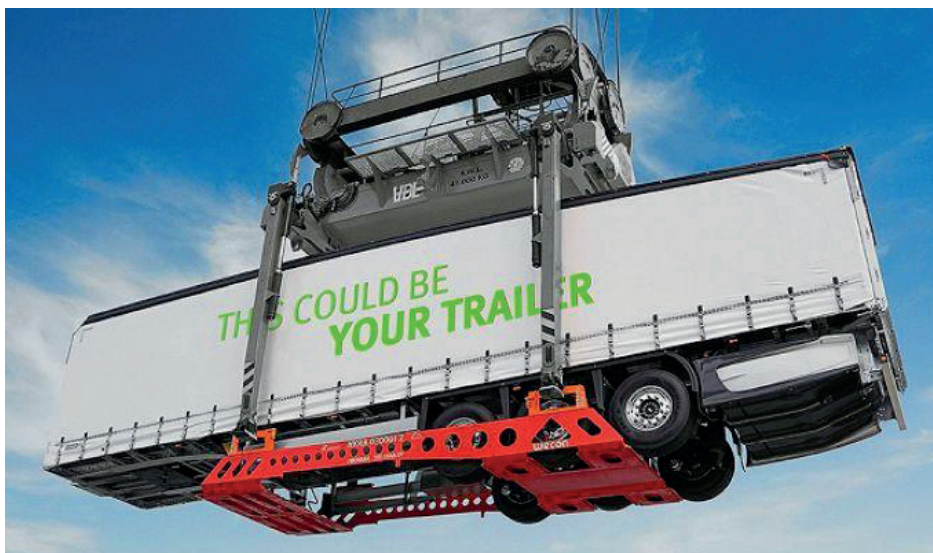
Rysunek 8. Trzecia generacja systemu przeładunkowego NiKRASA w postaci specjalistycznej platformy, zaprojektowana przez TX Logistik AG (Grupa Mercitalia)
