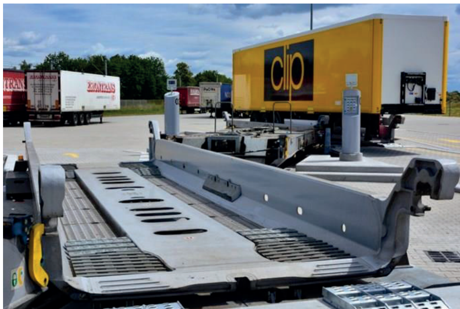
Rysunek 7. Terminal kontenerowy Clip Group SA Jasen (Swarzędz) posiada pierwsze w Polsce dwie stacje Lohr Railway System do poziomego rozładunku czterech naczep jednocześnie
