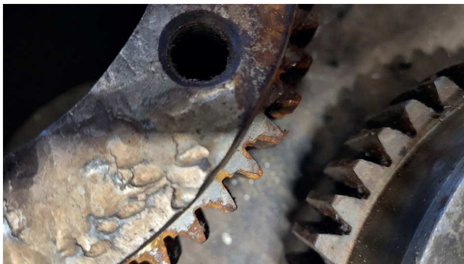
Rysunek 6. Zniszczone zęby piasty sprzęgła zębatego w porównaniu do nieuszkodzonych
