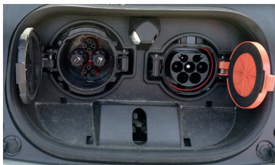
Rysunek 12. Gniazda ładowania europejskiego modelu Nissana Leafa. Po lewej stronie znajduje się charakterystyczne gniazdo CHAdeMO, po prawej – gniazdo Type 2, czyli obowiązujący na terenie Unii Europejskiej standard gniazd
