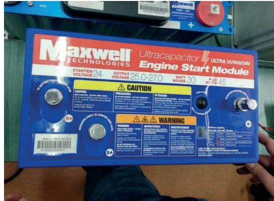
Rysunek 69. Superkondensator rozruchowy do samochodów spalinowych
