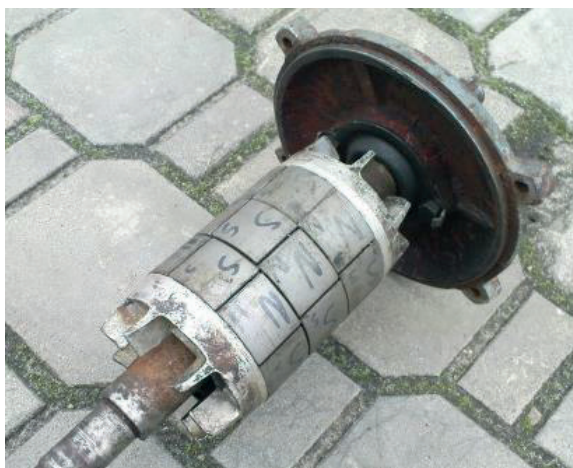
Rysunek 47. Wirnik silnika synchronicznego z magnesami trwałymi
