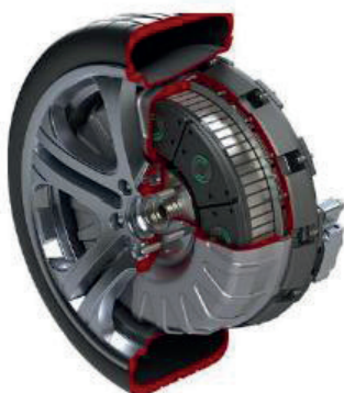
Rysunek 11. Przekrój napędu zintegrowanego z kołem
