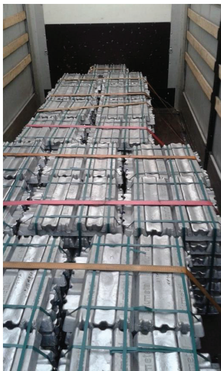
Rys. 6. Ładunek w postaci odlewów ołowiu w sztabkach na naczepie
