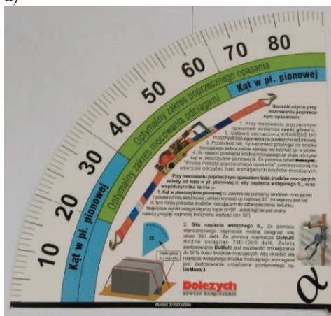
Rys. 9. Kątomierz Dolezych a) awers, b) revers
