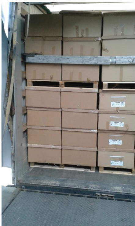
Rys. 2. Listwa blokująca ładunek na końcu naczepy
