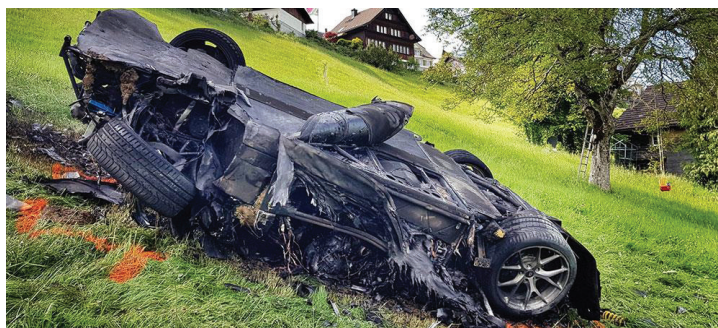
Rys. 3. Pojazd elektryczny po pożarze w wypadku
