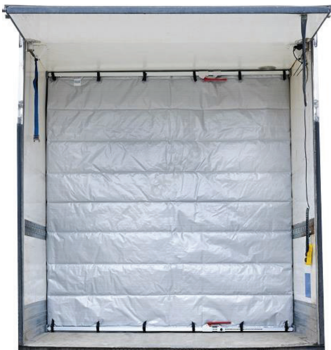
Rys. 10. Przykład ściany termoizolacyjnej w naczepie
