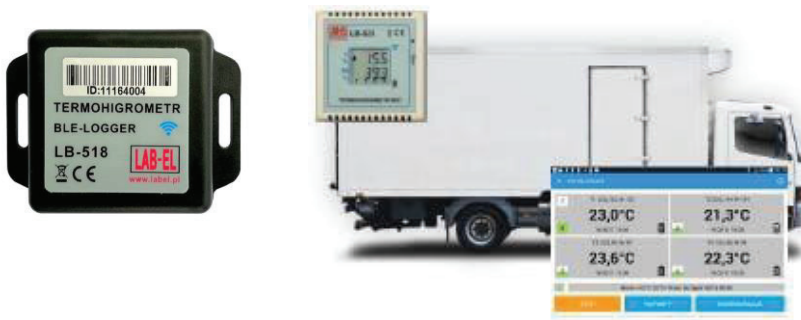
Rys. 2. Wykorzystany w badaniach rejestratory LB-518 i jego pozycja w systemie Trans-Logger-B
