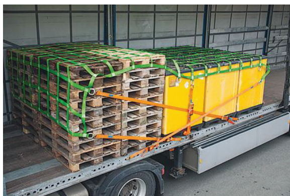
Rys. 6. Siatka zabezpieczająca towar
