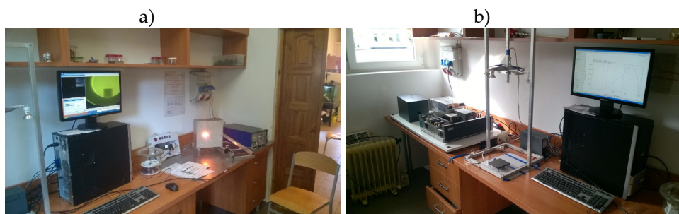
Rys. 45. Stanowisko do wyznaczania charakterystyki topliwości popiołu (a), stanowisko pomiaru przepuszczalności świetlnej folii (b)
