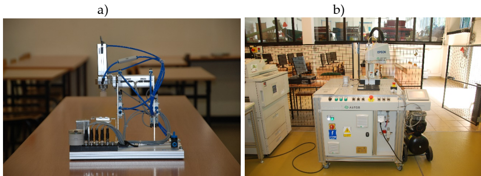
Rys. 32. Model linii sortującej z manipulatorem (a) oraz robot SCARA do pakowania i sortowania produktów (b)
