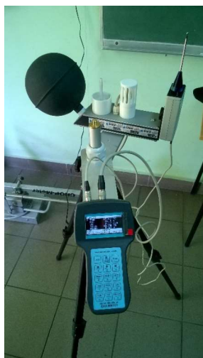
Rys. 37. Aparatura do badań ergonomicznych: miernik mikroklimatu EHA MM101 (a), miernik do pomiaru poziomu dźwięku, wielkości drgań miejscowych i ogólnych SVAN 958 (b), luksomierz L-50 (c)
