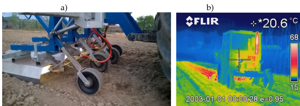
Rys. 40. Urządzenie do termicznej eliminacji chwastów (a) oraz widok obrazu z kamery termowizyjnej (b)
