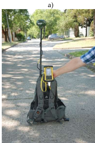
Rys. 35. Zestaw do badań z zakresu rolnictwa precyzyjnego: przenośny odbiornik GPS (a) wraz z wizualizacją map zasobności gleby (b)
