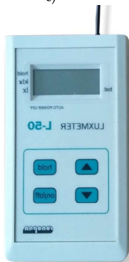
Rys. 37. Aparatura do badań ergonomicznych: miernik mikroklimatu EHA MM101 (a), miernik do pomiaru poziomu dźwięku, wielkości drgań miejscowych i ogólnych SVAN 958 (b), luksomierz L-50 (c)
