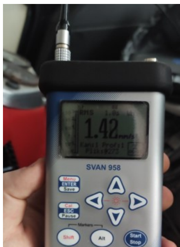
Rys. 37. Aparatura do badań ergonomicznych: miernik mikroklimatu EHA MM101 (a), miernik do pomiaru poziomu dźwięku, wielkości drgań miejscowych i ogólnych SVAN 958 (b), luksomierz L-50 (c)
