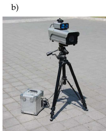
Rys. 42. Stanowisko do badania elementów elektronicznych z zakresu mechatroniki (a) oraz radar do pomiaru prędkości jazdy (b)
