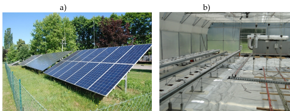
Rys. 18. Stanowisko do badania efektywności konwersji promieniowania słonecznego w panelach PV w energię elektryczną (a) wraz z magazynowaniem energii w akumulatorze zmiennofazowym (PCM) (b)
