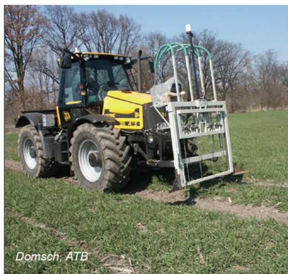
Rysunek 4.11. Penetrometr 4-elementowy do pomiaru w pionie profilu
