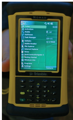
Rysunek 3.28. TRIMBLE NOMAD, odbiornik przeznaczony dla bardziej wymagających
