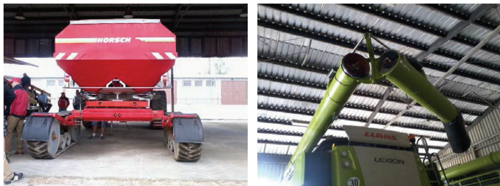
Rysunek 7.2. Maszyny przystosowane do systemu CTF
