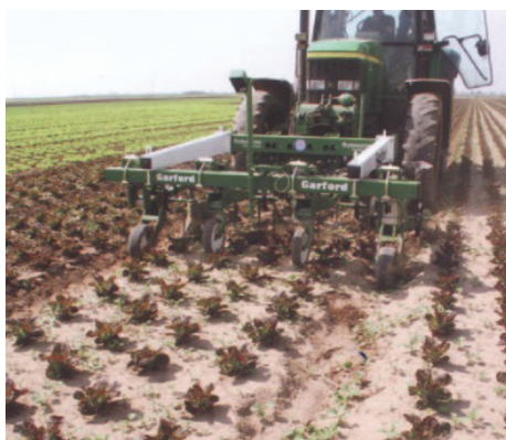
Rysunek 7.18. System prowadzenia pielńnika na podstawie kolorowego obrazu z kamery
