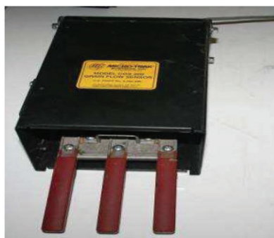
Rysunek 5.5 System Fieldstar Micro-Trak Grain-Trak AGCO - pomiar plonu za pomocą „palców” pomiarowych
