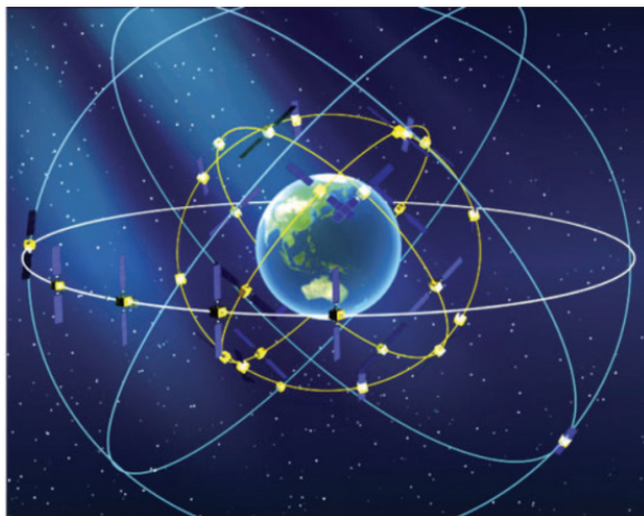
Rysunek 3.4. Orbitsy satelitów systemu BEIDOU
