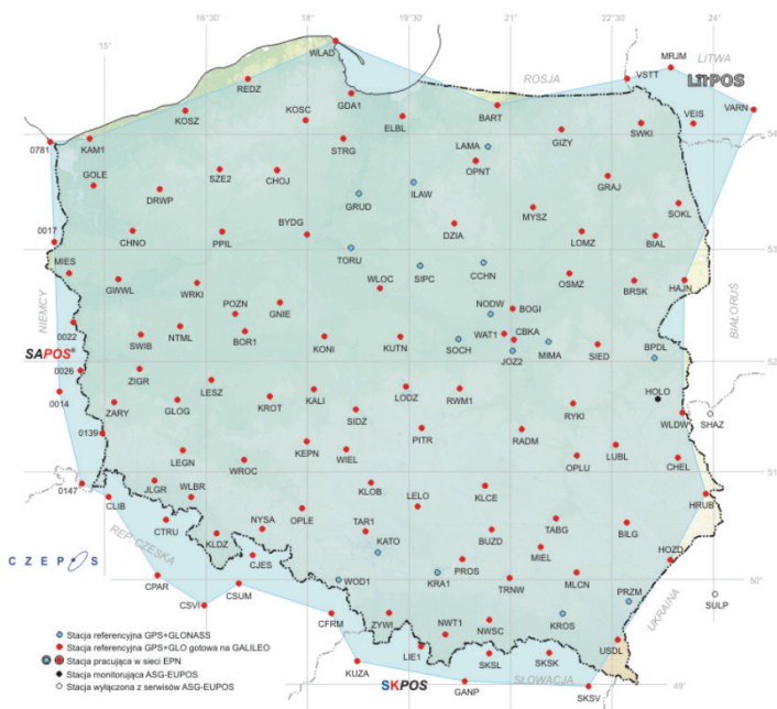
Rysunek 3.21. Rozmieszczenie stacji referencyjnych systemu ASG-EUPOS
