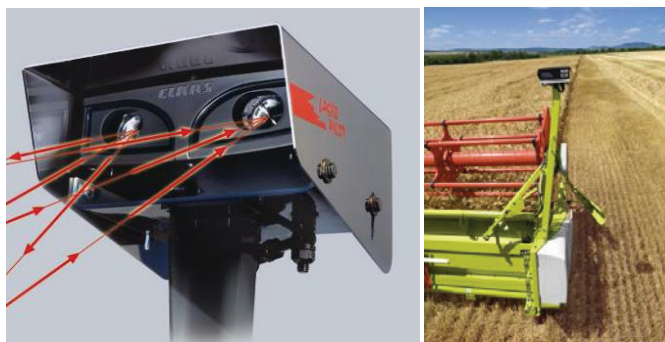
Rysunek 7.22. Czujnik laserowy LASER PILOT
