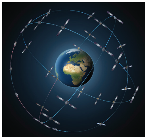
Rysunek 3.3. Orbity satelitów systemu GALILEO
