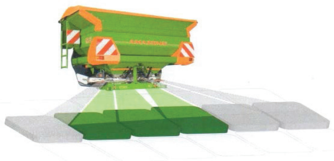
6-stopniowe włączanie sekcji szerokości w rozsiewaczu ZA-M Profis Hydro
