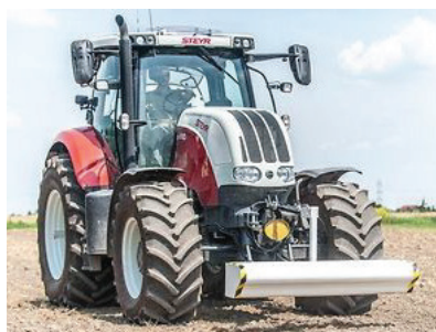
Rysunek 4. 24. Czujnik TSM i rozmieszczenie elementów systemu na ciągniku: 1 – czujnik, 2 – terminal, 3 – antena DGPS, 4 – wyjście parametrów do sterowania maszyną
