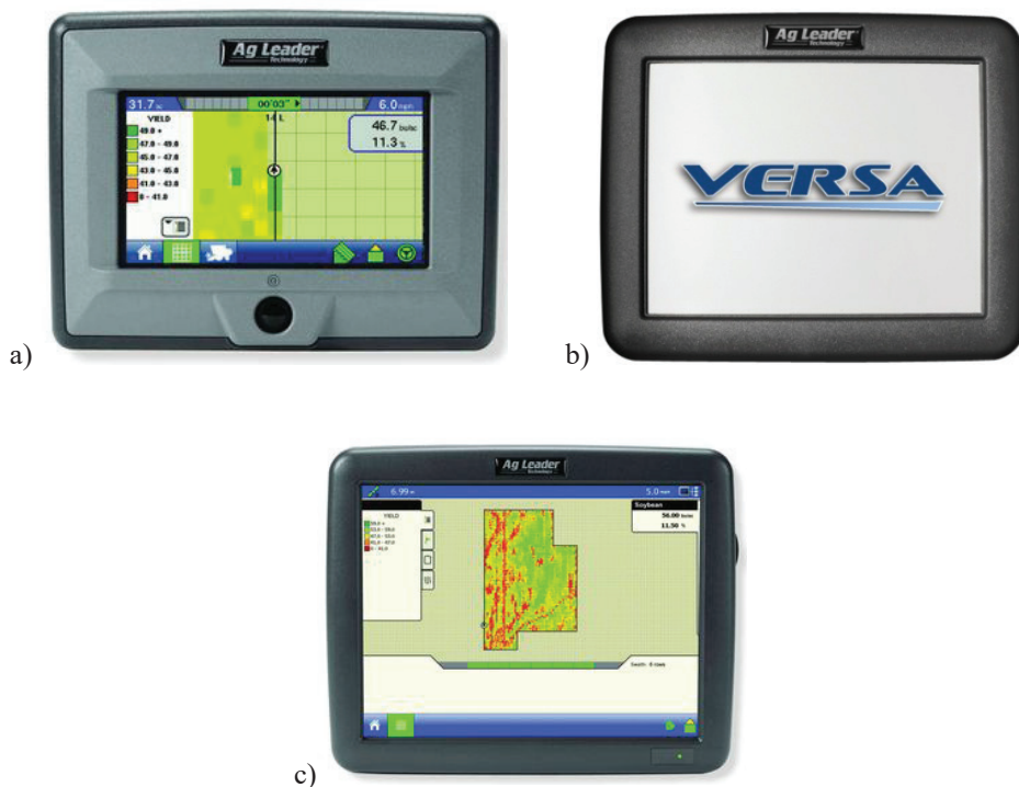
Rysunek 5.9. Terminale AgLeader: a) EDGE, b) VERSA, c) INTEGRA
