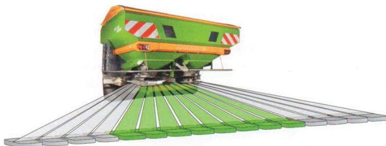
8 lub 16 stopniowe włączanie sekcji szerokości w ZA-TS
