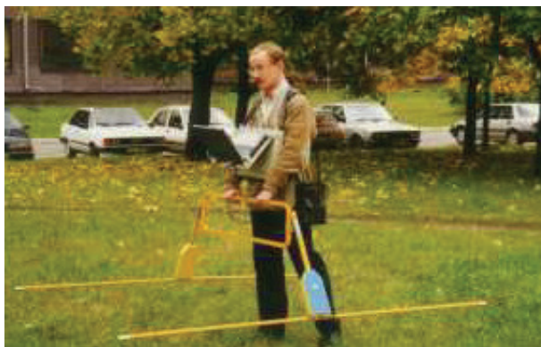
Rysunek 4.26. Pomiary georaderem –profilowanie
