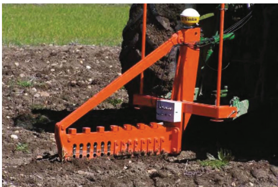
Rysunek 4.6. Składowe systemu do pomiaru zagęszczenia podglebia: (1), (2), (3), (4) – ostrza tnące, (5) – ostrze tarcia
