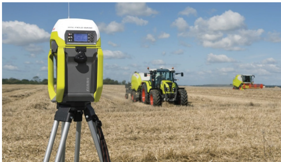
Rysunek 3.22. Przenośna stacja bazowa RTK firmy CLAAS
