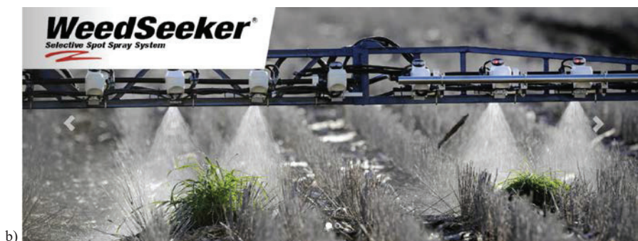
Rysunek 6.18. Oprysk z użyciem czujników WeedSeeker: a) zasada działania, b) przykład pracy
