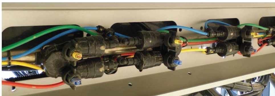
Rysunek 6.16. Rozmieszczenie rozpylaczy co 0,25 m
