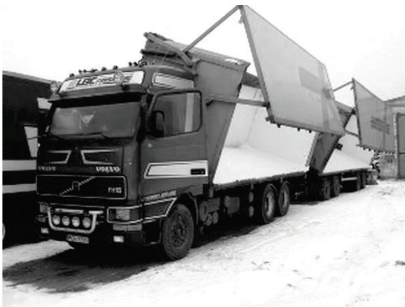
Rys. 4. Pojazd samowyładowczy stosowany do przewozu biomasy sypkiej
