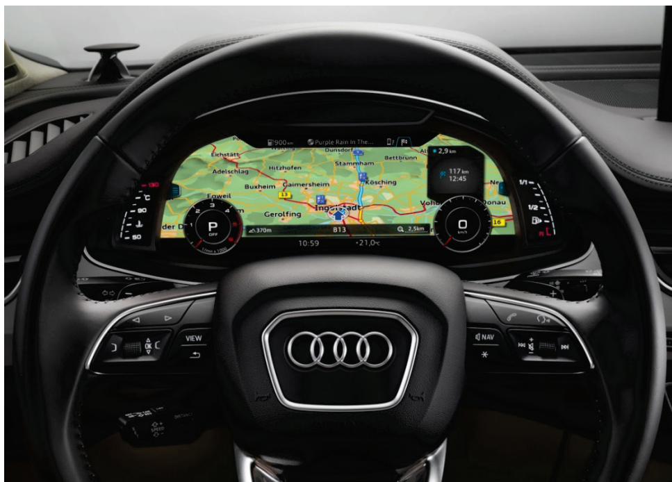
Rys. 3. Widok na virtual cockpit umieszczony w miejscu tradycyjnych zegarów w modelu Audi Q7 II
