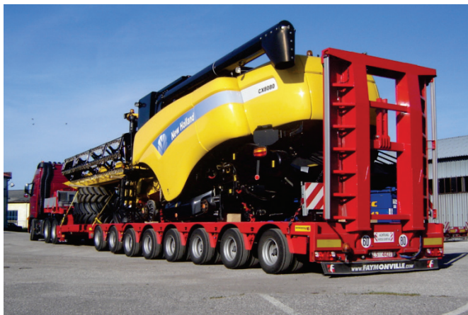
Rys. 7. Przewóz kombajnu zbożowego ze zdemontowanymi kołami łącznie z hederem na naczepie z płaskim pokładem firmy Faymonville
