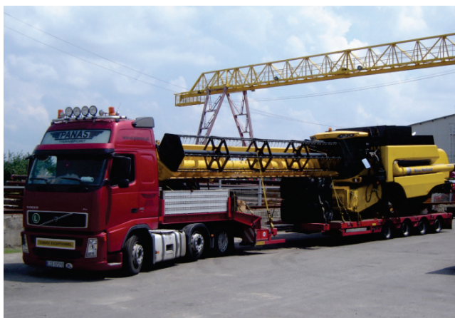
Rys. 8. Załadunek kombajnu zbożowego ze zdemontowanymi kołami łącznie z hederem na naczepie za pomocą suwnicy
