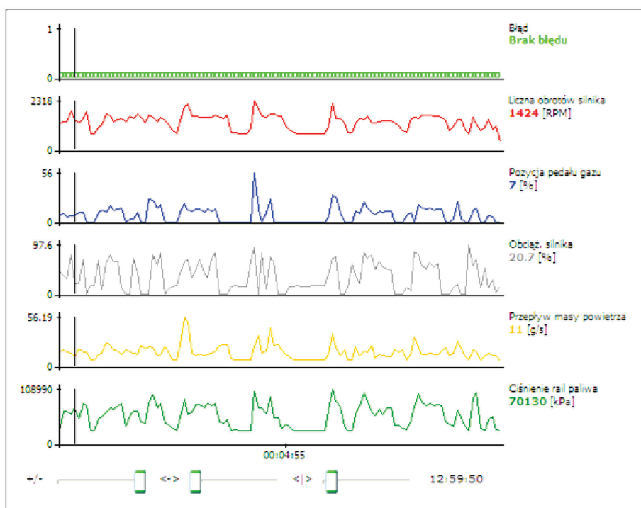
Rys.10. Charakterystyki pracy silnika ze skanera OBD Log
