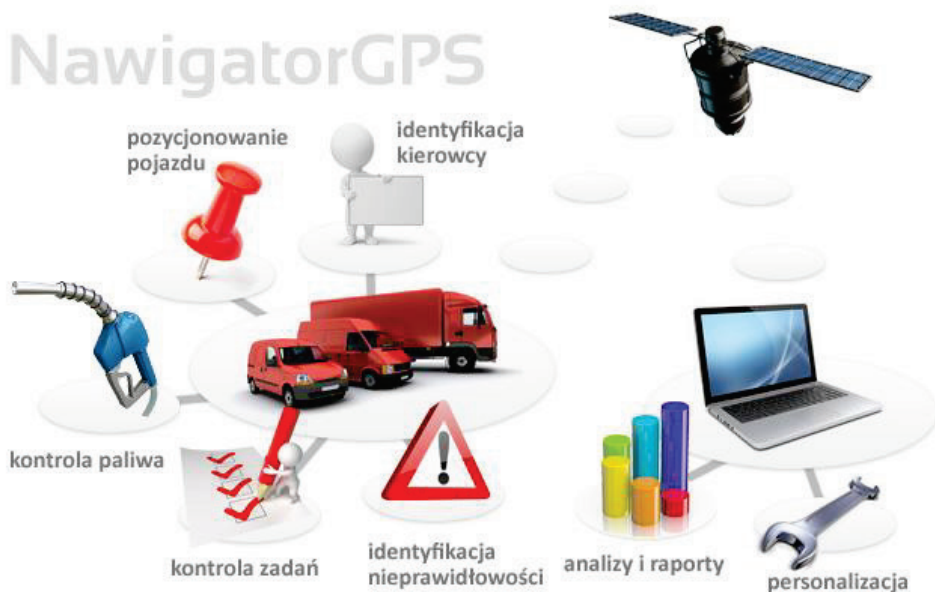
Rys. 7. Funkcje użytkowe w systemie monitoringu GPS pojazdów w transporcie drogowym.
