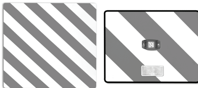
Rys. 6. Przykład tablic do oznakowywania ładunku wystającego z przodu
