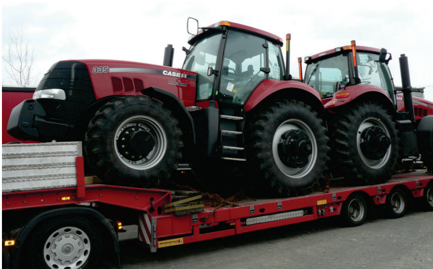
Rys. 6. Transport dwóch ciągników rolniczych na naczepie niskopodwoziowej
