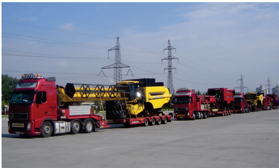
Rys. 2. Przewóz kombajnów zbożowych w konwoju na naczepach niskopodwoziowych łącznie z hederem
