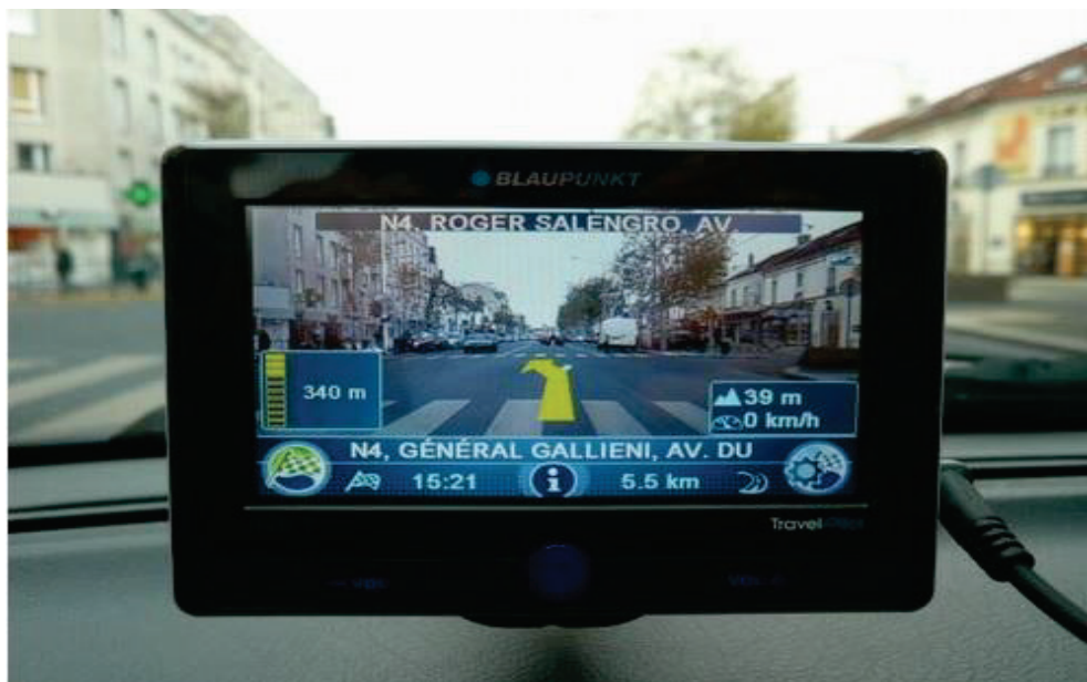
Rys. 4. Przykład przenośnego odbiornika nawigacji samochodowej firmy BLAUPUNKT, który umożliwia video nawigację
