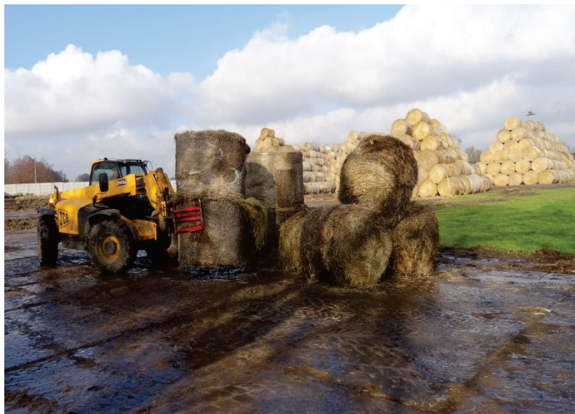
Rys. 5. Dostarczenie surowca na linię produkcyjną ładowarką teleskopową
