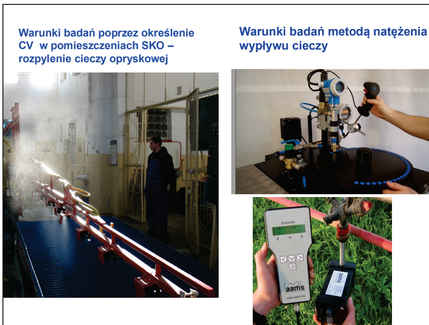
Rys. 6. Warunki pracy personelu Stacji Kontroli Opryskiwaczy (SKO) podczas kontroli stanu technicznego rozpylaczy rolniczych.
