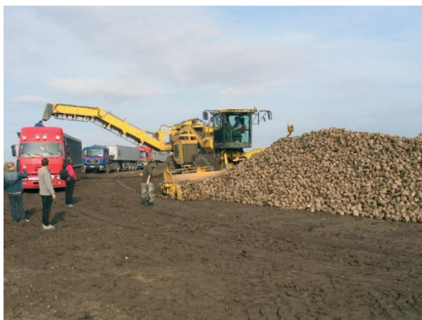
Rys. 6. Zmechanizowany załadunek buraków cukrowych na środki transportowe z wykorzystaniem oczyszczarko-ładowarki
