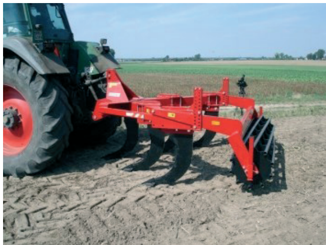
Rys. 7. Głębosz do spulchniania gleby; jego głębokość robocza sięga zwykle ok. 0,7 m
