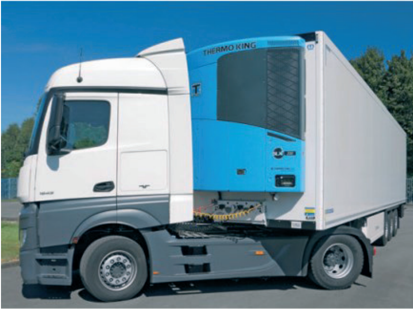
Rys. 8. Agregat Thermo King SLXi 300 wyposażono w hybrydowy napęd Enviro Drive FRIGOBLOCK
