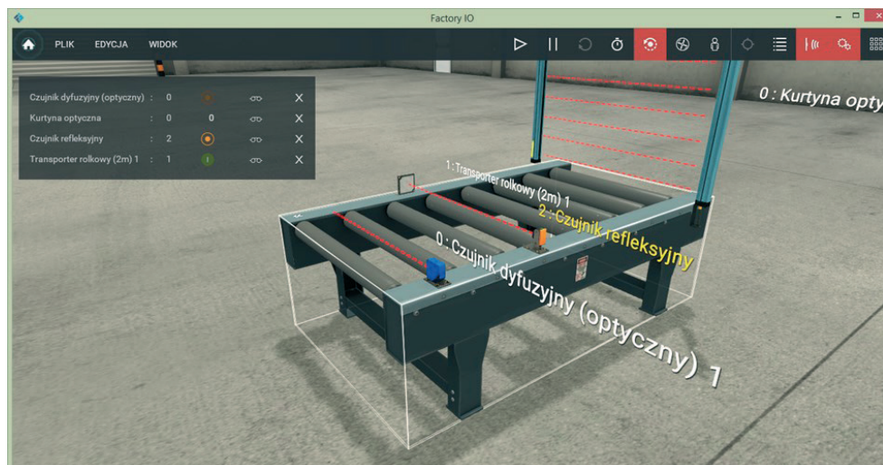
Rys. 18. Transporter rolkowy z wybranymi czujnikami detekcyjnymi
