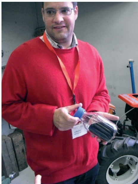
Rys. 12. Węglowodory (sadza zebrana do szklanego pojemnika) po godzinie pracy silnika spalinowego do napędu kosiarki do traw.
