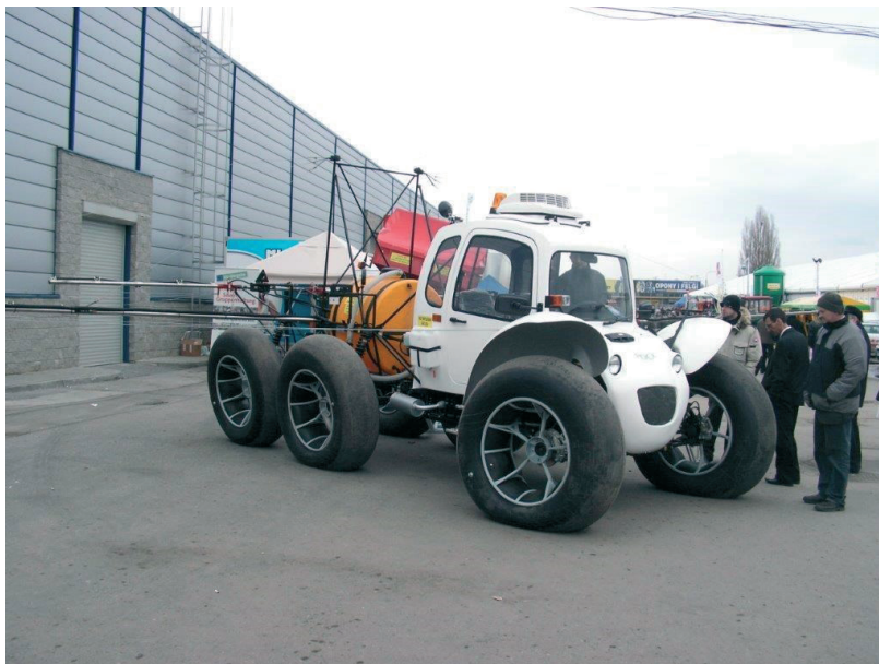
Rys. 10. Opony ciągnika do pracy na terenach bagiennych.
