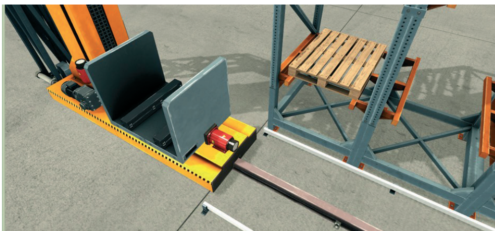
Rys. 13. Pozycja bazowa wózka układnicy magazynowej
