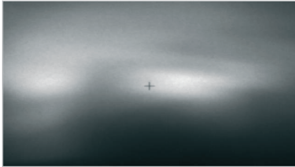
Rys. 7. Niedokładnie osadzona żarówka w gnieździe – nieprawidłowa granica światła i cienia, oślepianie nadjeżdżających z przeciwnika (badania własne)
