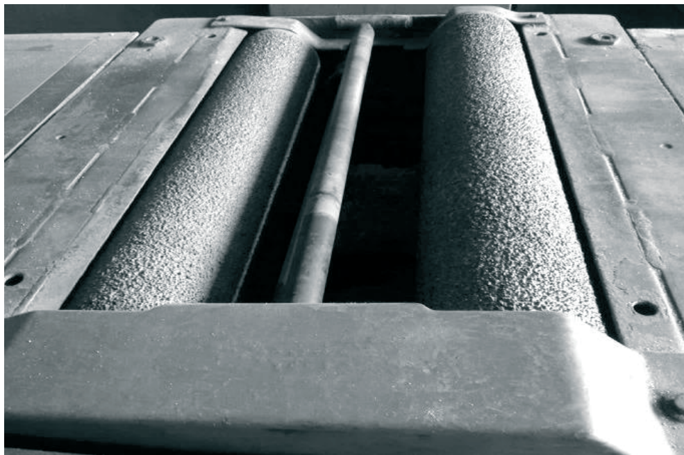
Rys. 30. Uniwersalne urządzenie rolkowe do badań sił hamowania (fot. KEiŚT) Fig. 30. Universal roller brake tester (photo by KEiŚT)
