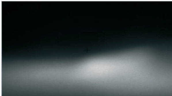
Rys. 8. Skorygowane położenie żarówki – granica światła i cienia obecna, brak oślepiania nadjeżdżających z przeciwnika (badania własne)
