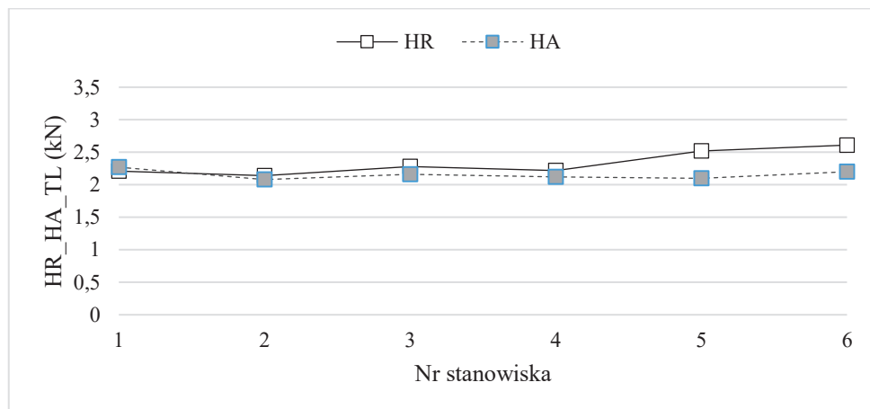
Rys. 74. Zestawienie wyników pomiarów sił hamowania hamulcem roboczym i awaryjnym dla tylnego lewego koła pojazdu nr 2
