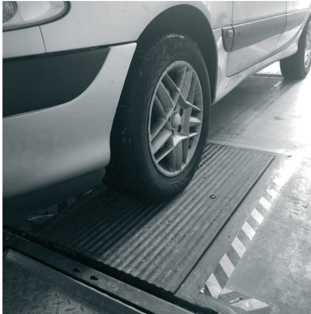
Rys. 39. Przejazd pojazdu przez urządzenie płytowe do kontroli ustawienia kół jezdnych (fot. KEiŚT)
