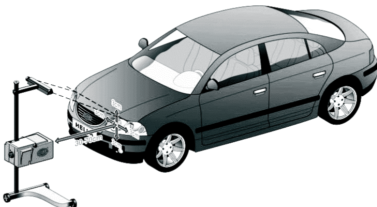
Rys. 110. Pozycjonowanie urządzenia do kontroli reflektorów względem pojazdu (HELLA, 2019)
