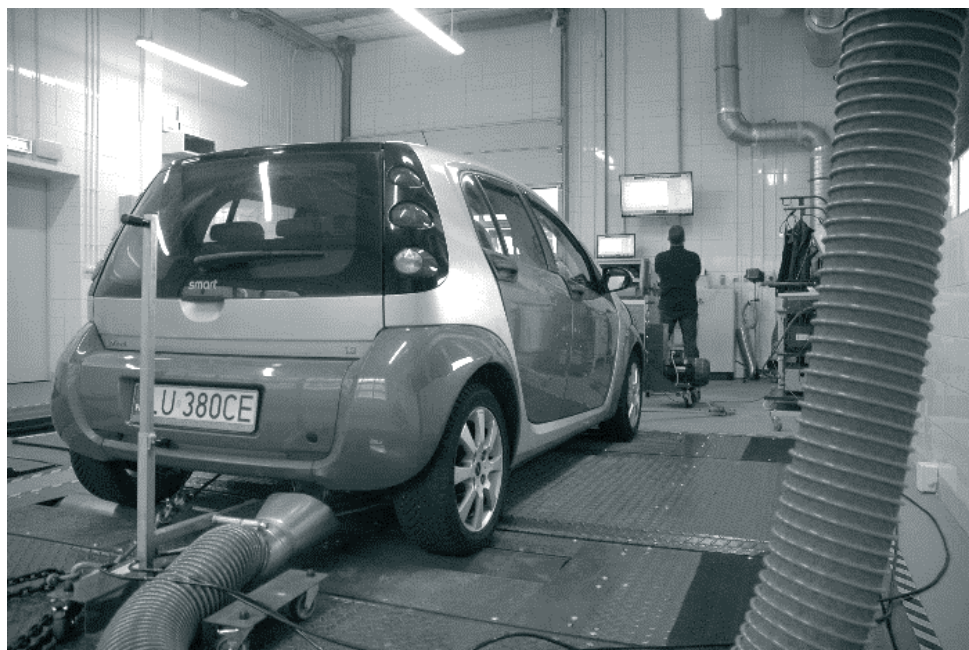
Rys. 12. Samochód w badaniach diagnostycznych na stanowisku dynamometrycznym laboratorium (badania własne)
