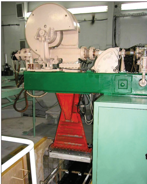
Rysunek 3. Widok urządzenia do utrwalania promieniowaniem jonizującym. Głowica kieruje odchyloną wiązkę promieni z akceleratora na pojemniki znajdujący się poniżej na podajniku rolkowym
