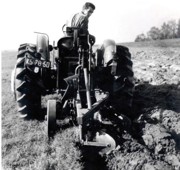
Mgr inż. J. Kowalski wykonuje orkę z wykorzystaniem systemu regulacji kopiującej
