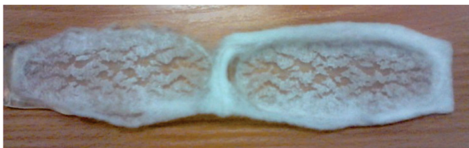
Rys. 85. Oddzielone dwie warstwy kompozytu (Jalbrzykowski i in., 2016)
