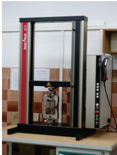
Rys. 39. Widok maszyny wytrzymałościowej Zwick/Roell Z010
