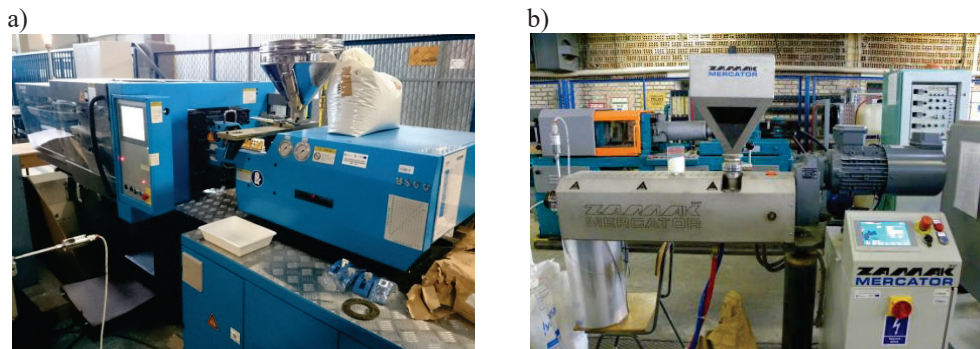
Rys. 35. Widok: a) wtryskarki Borche BS60, b) wyciarki EHP25ELine
