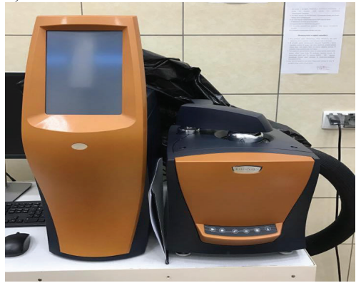
Rys. 38. Widok: a) analizatora termograwimetrycznego TGA Q500, TA Instruments, b) różnicowego kalorymetru skaningowego DSC Discovery
