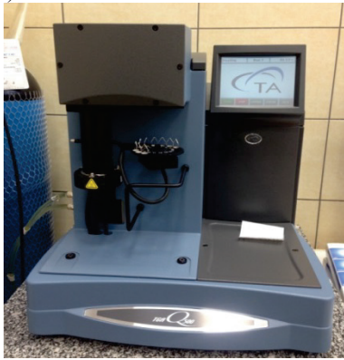
Rys. 38. Widok: a) analizatora termograwimetrycznego TGA Q500, TA Instruments, b) różnicowego kalorymetru skaningowego DSC Discovery
