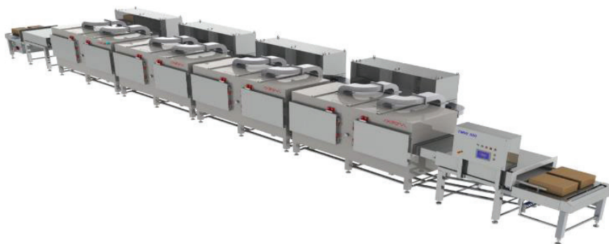
Rys. 78. Tunel temperujący mikrofalowy 915 MHz TMW 300 (wydajność: 8000 do 12 000 kg/h w zakresie od -20^{\circ}\text{C} do -4^{\circ}\text{C} / -2^{\circ}\text{C} ) ( www.sairem.com )
