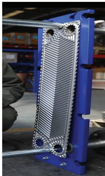
Rys. 26. Parownik płytowy produkowany przez firmę HFM ( www.hofmann-heatexchanger.com ) a) widok złożonego parownika, b) widok pojedynczej płyty.
