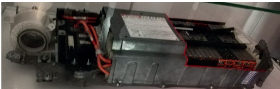
Rysunek 76. Niklowo – wodorkowa bateria samochodu hybrydowego TOYOTA Prius (napięcie nominalne 201,6V)
