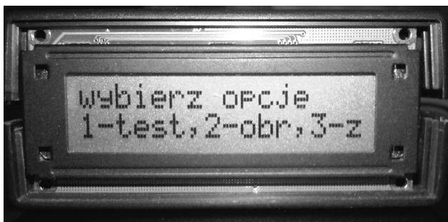
Rys. 39. Widok wyświetlacza LCD z menu wyboru
