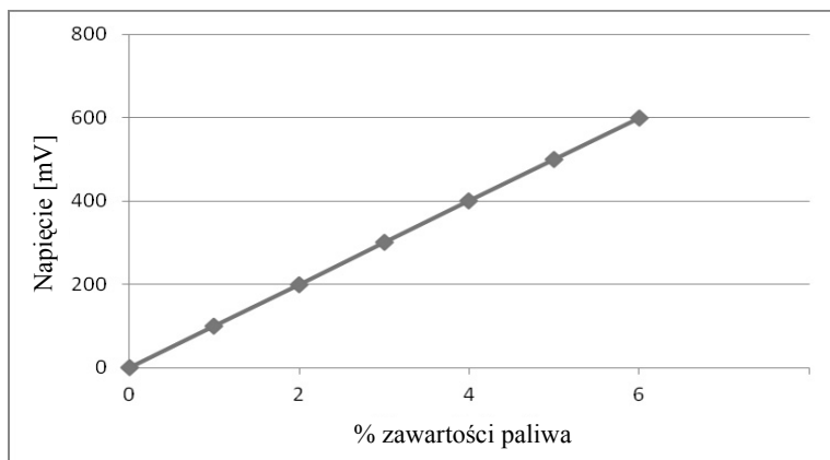
Rys. 42. Wykres kalibracyjny przyrządu, zależność napięcia na wyjściu modułu pomiarowego [mV] w funkcji procentowej zawartości paliwa w oleju
