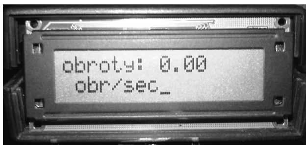
Rys. 40. Widok wyświetlacza LCD modułu podczas pracy w trybie obrotomierza
