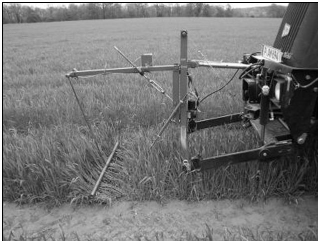
Rys. 6. Sposób montażu czujnika Crop-Meter
