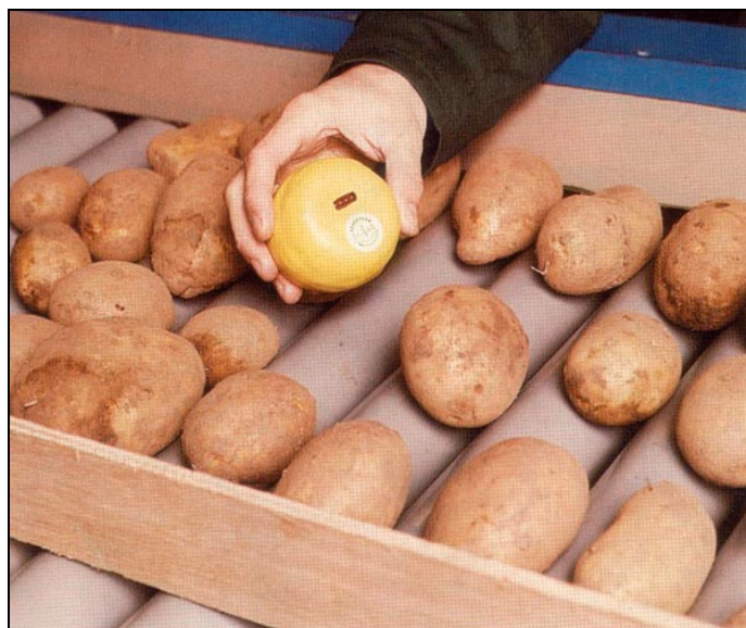
Rys. 9. Elektroniczna bulwa w ciągu technologicznym przygotowania bulw ziemniaka do sprzedaży
