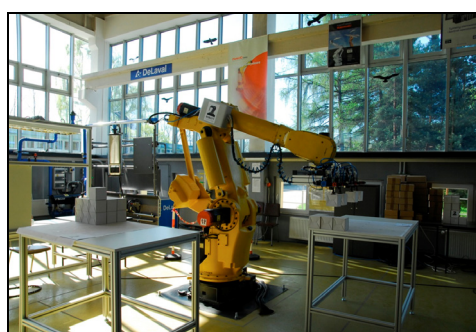
Rys. 3.17. Laboratorium robotyzacji procesów technologicznych – robot Fanuc iF S420 RJ2
