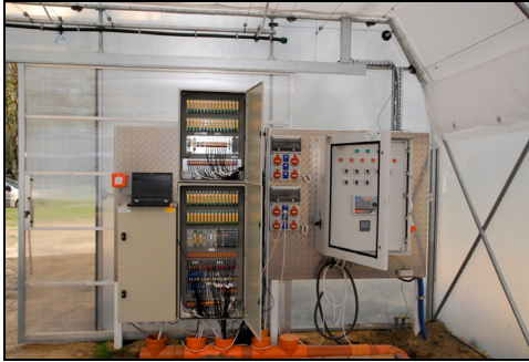
Rys. 3.9. Stanowisko laboratoryjne w tunelu foliowym wyposażone w komputerowy system pomiarowy wraz z Data Loggerem (po lewej) oraz komputer klimatyczny (po prawej)
