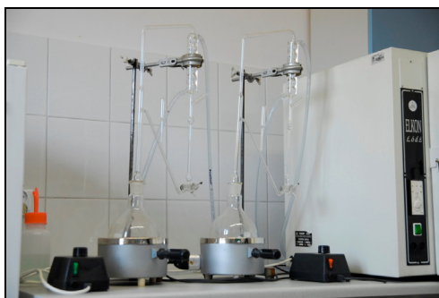
Rys. 3.4. Stanowisko do destylacji olejków eterycznych (aparat Derynga)
