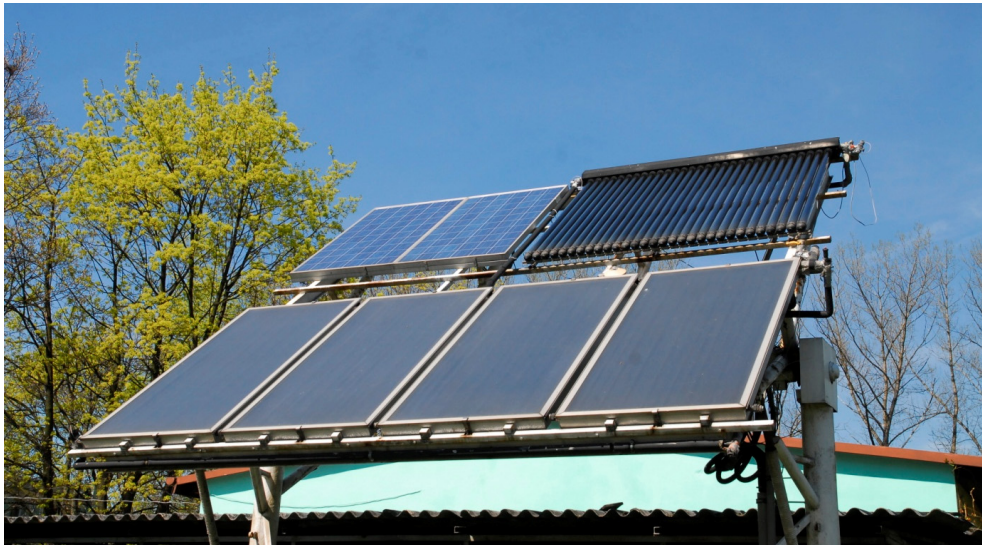
Rys. 3.11. Widok stanowiska umożliwiającego zmianę kąta położenia czterech płaskich kolektorów cieczowych, kolektora próżniowego (30 rur) oraz dwóch paneli fotowoltaicznych
