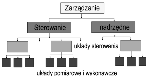
Rysunek 47. Hierarchiczny system sieci przemysłowych
