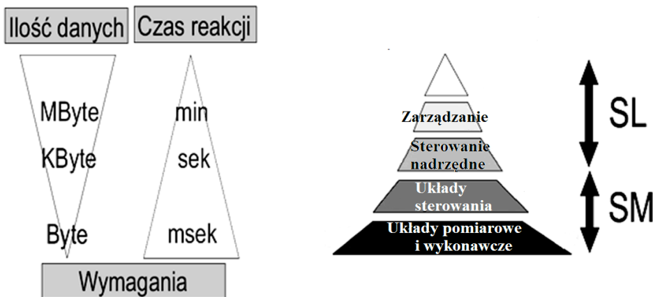
Rysunek 49. Porównanie sieci miejscowych i lokalnych
