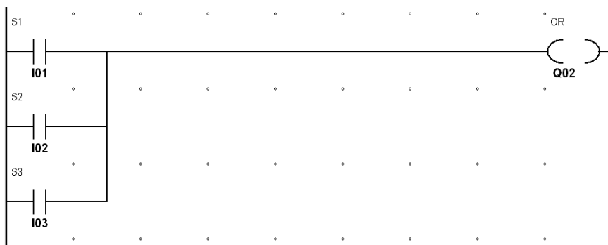
Rysunek 29. Zapis funkcji OR w języku schematów drabinkowych
