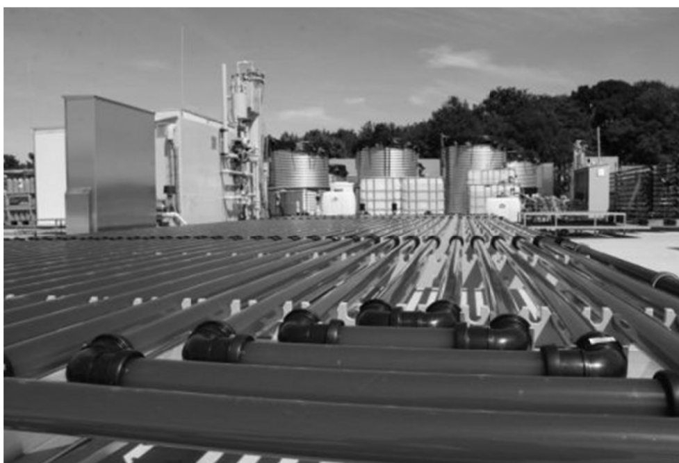
Rysunek 2.4. Hodowla alg w horyzontalnych reaktorach rurowych w Hogesschool Zeeland we współpracy z Uniwersytetem Wageningen
