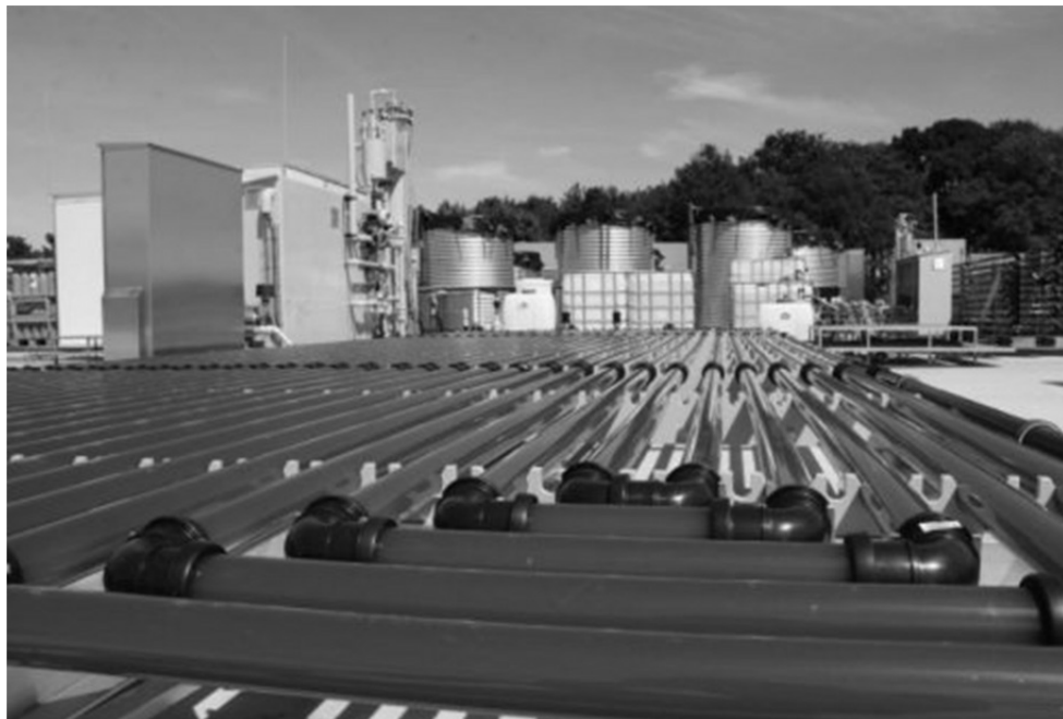
Rysunek 2.4. Hodowla alg w horyzontalnych reaktorach rurowych w Hogeschool Zeeland we współpracy z Uniwersytetem Wageningen
