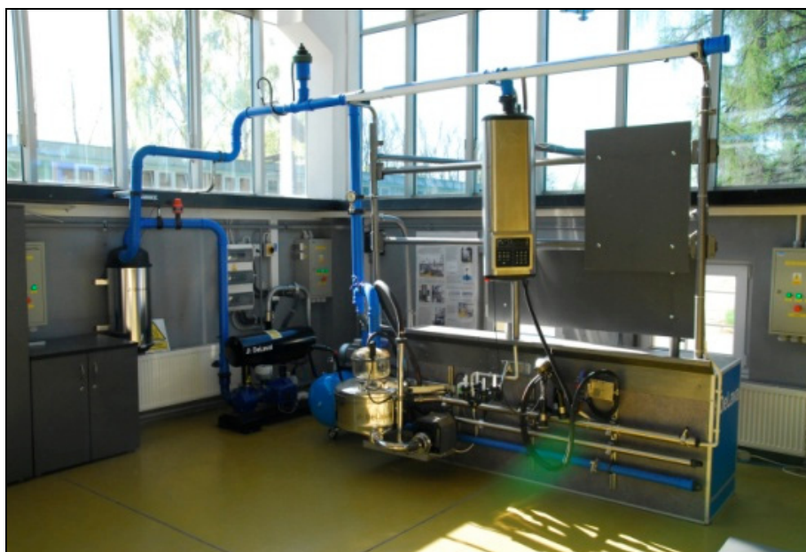
Fot. 13. Laboratorium robotyzacji procesów technologicznych – instalacja udojowa
