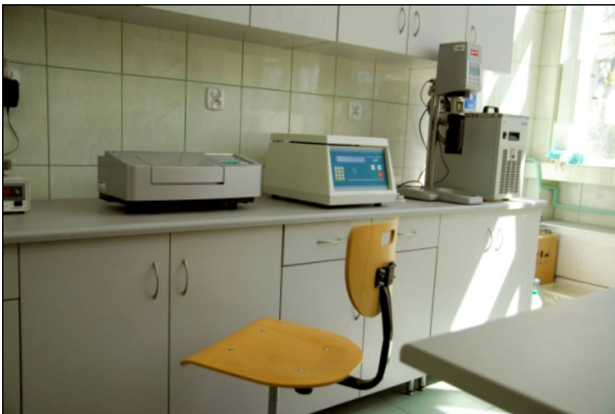
Fot. 4. Stanowisko do analizy jakości produktów żywnościowych (polarymetr P300, wirówka laboratoryjna, homogenizator)
