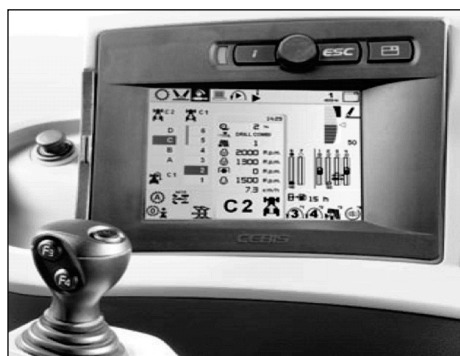
Rys. 2. Terminal sterujący CEBIS zamontowany w kabinie ciągnika CLAAS Arion [Mat. inf. CLAAS 2011]
