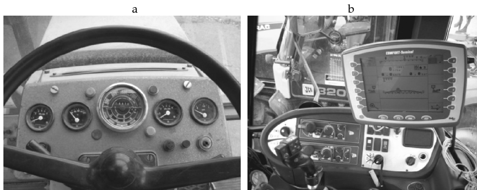
Rys. 2. Urządzenia sygnalizacyjne: (a) ciągnika z lat 70-tych i (b) mobilny komputer pokładowy współczesnego ciągnika zgodny normą ISO 11783-6 (Part 6: Virtual terminal)
