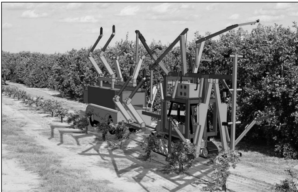
Rys. 4. Postać koncepcyjna robota do zbioru owoców
