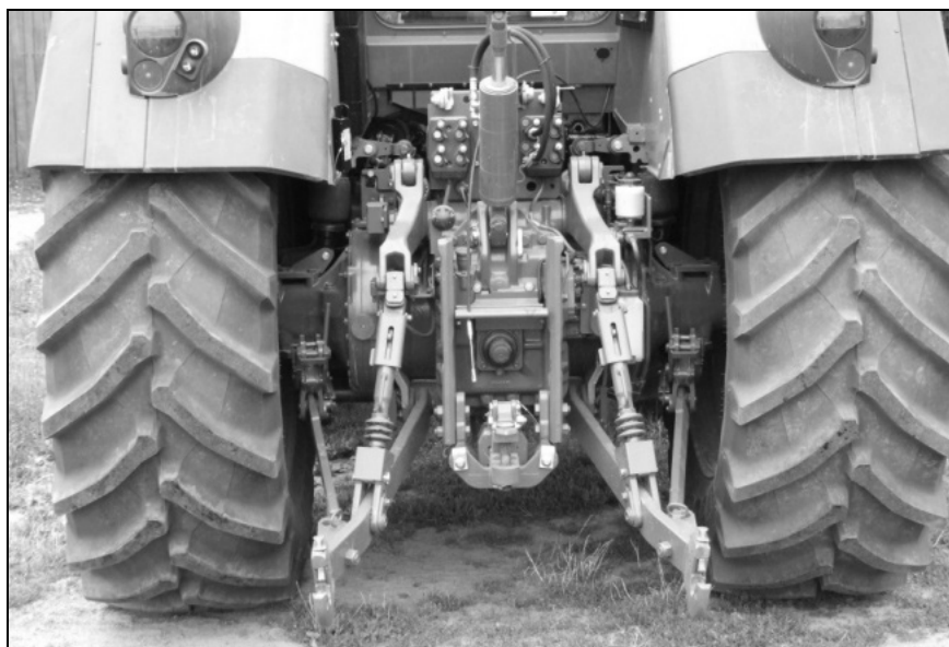
Rys. 6. System Walterschied umożliwiający łączenie i rozłączanie maszyny z ciągnikiem bez potrzeby puszczenia stanowiska pracy
