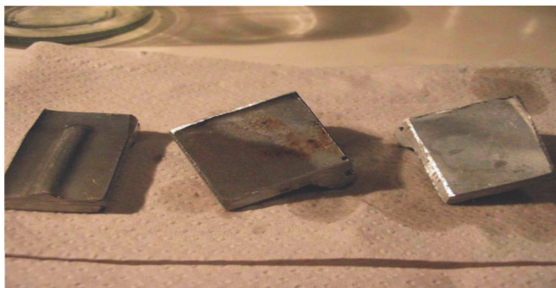
Rysunek 8.6.2. Fotograficzny obraz obudowy pompy wtryskowej (stop AK7) – (od lewej): test w kontakcie z biopaliwem, – test w kontakcie z ON, – stan wyjściowy próbki
