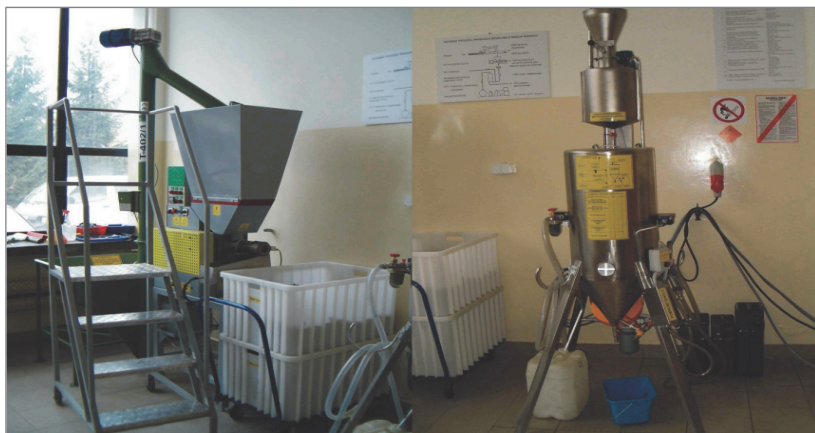
Rysunek 8.2.1. Prasa śrubowa i estryfikator W60 firmy PROMAR – laboratorium biopaliw WA
