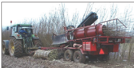
Rysunek 5.4.20. Maszyna Bundler firmy Salixphere do zbioru pędów drzew szybkorosnących w formie wiązek
