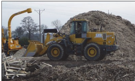
Rysunek 6.2.3. Sposoby załadunku: a) bezpośredni załadunek z maszyny rozdrabniającej, b) ładowarka czołowa wykorzystywana do załadunku środków materiałem rozdrobnionym
