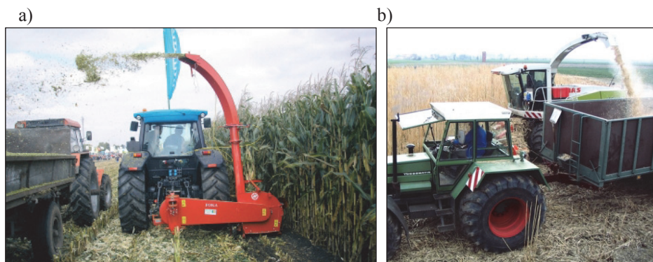
Rysunek 5.4.7. Maszyny do zbioru jednoetapowego; a – sieczkarnia zawieszana na ciągniku, b – sieczkarnia samojezdna
