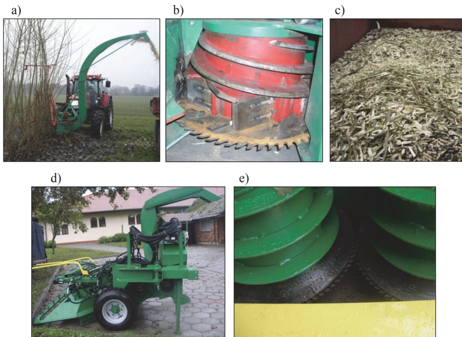
Rysunek 5.4.11. Maszyna zawieszana do zbioru jednoetapowego drzew szybkorosnących: a – urządzenie opracowane w ATB Poczdam, b – elementy robocze, c – zrębki uzyskane z topoli, d – prototyp maszyny opracowany na SGGW, e – elementy robocze – ścinające rośliny
