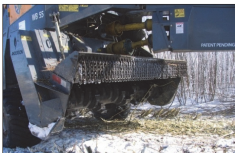
Rysunek 5.4.19. Maszyna BIOBALER; a – bębnowy system tnący, b – plantacja po zbiorze
