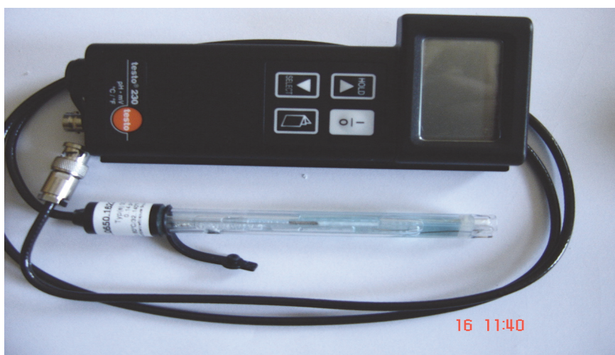
Rysunek 8.1.1. Przyrząd pomiarowy – PH- metr firmy TESTO model 230
