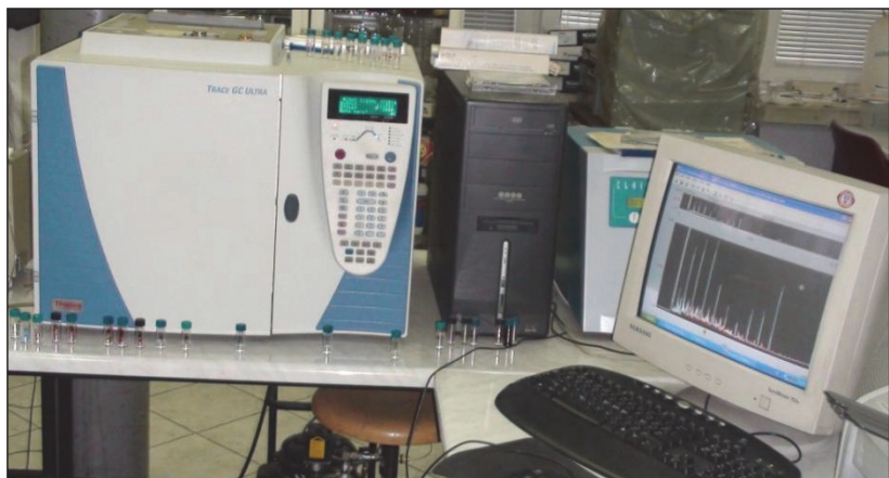
Rysunek 7.6.1. Stanowisko badawcze wyposażone w wielkanałowy chromatograf gazowy firmy Thermo typ TRACE GC Ultra
