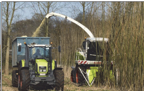
Rysunek 6.2.5. Odbiór biomasy w postaci rozdrobnionej a) samochód z kontenerem wymiennym, b) zestaw ciągnikowy z podniesionymi burtami
