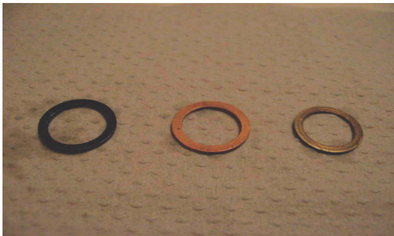
Rysunek 8.6.1. Fotograficzny obraz uszczelki miedzianej przewodu zasilającego pompę wtryskową (od lewej): – poddaną działaniu testu biopaliwa, – podkładka w stanie wyjściowym, – podkładka poddana działania ON w warunkach testowych
