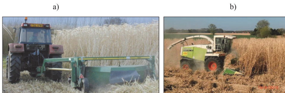
Rysunek 5.4.8. Koszenie pędów miskanta: a) kosiarka dyskową, b) miskanta sieczkarnią samojezdną
