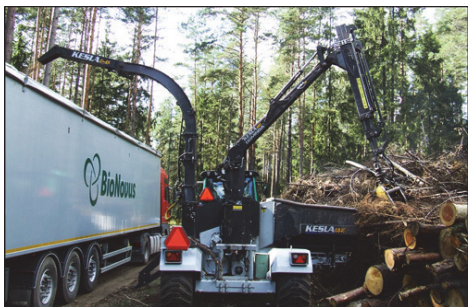
Rysunek 6.2.3. Sposoby załadunku: a) bezpośredni załadunek z maszyny rozdrabniającej, b) ładowarka czołowa wykorzystywana do załadunku środków materiałem rozdrobnionym
