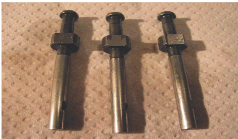
Rysunek 8.6.3. Fotograficzny obraz tłoczka sekcji tłoczącej pompy wtryskowej (od lewej): – stan wyjściowy, – test w kontakcie z ON, – test w kontakcie z biopaliwem
