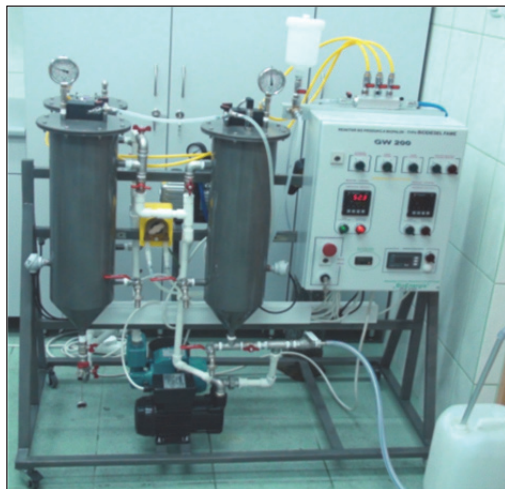
Rysunek 7.3.1. Reaktor GW 100 (200) do produkcji biopaliw typu Biodiesel FAME (RME)
