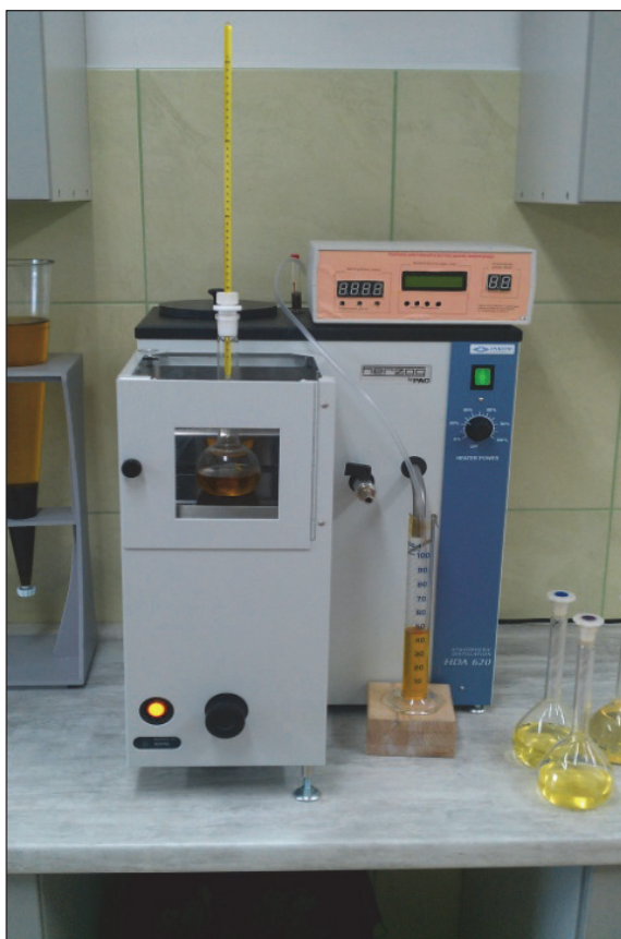
Rysunek 7.7.1. Stanowisko badawcze wyposażone w destylarkę HAD 620/1 firmy Herzog
