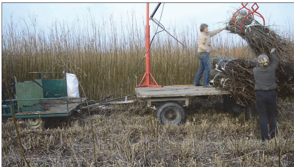
Rysunek 5.4.16. Kosiarka do ścinania pędów wierzby; a i b – widok kosiarki, c – platforma do odbioru ściętych pędów wraz z przyczepą transportową
