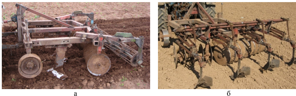
Рис. 2. Комбинированный почвообрабатывающий агрегат КПА-2,2 в комплектации с прикатывающим катком (а) и с гребнеобразующими корпусами (б)
