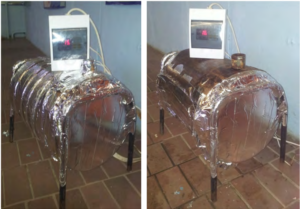
Рисунок 4. Ёмкость с углом обхвата тепловой лентой: а – 360^\circ ; б – 90^\circ
